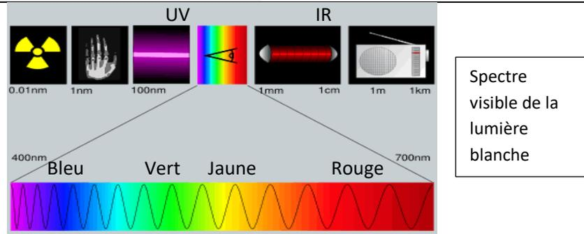
**A l'aide d'un spectroscope à main, qui permet de décomposer la lumière blanche, observer le spectre de la lumière blanche.** Attention, ce type de spectroscope montre une série de spectres (tous identiques allant du bleu au rouge).
