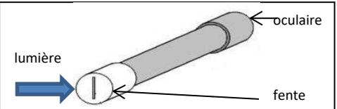
Observer ensuite le spectre de la lumière blanche à l'aide du spectroscope à main mais en intercalant cette fois la solution de chlorophylle extraite dans l'étape 1. Pour cela **remplir au 3/4 la petite cuve à faces parallèles** et la placer devant la fente du spectroscope à environ 1 cm. Comparer les spectres observés avec et sans la solution de chlorophylle.
