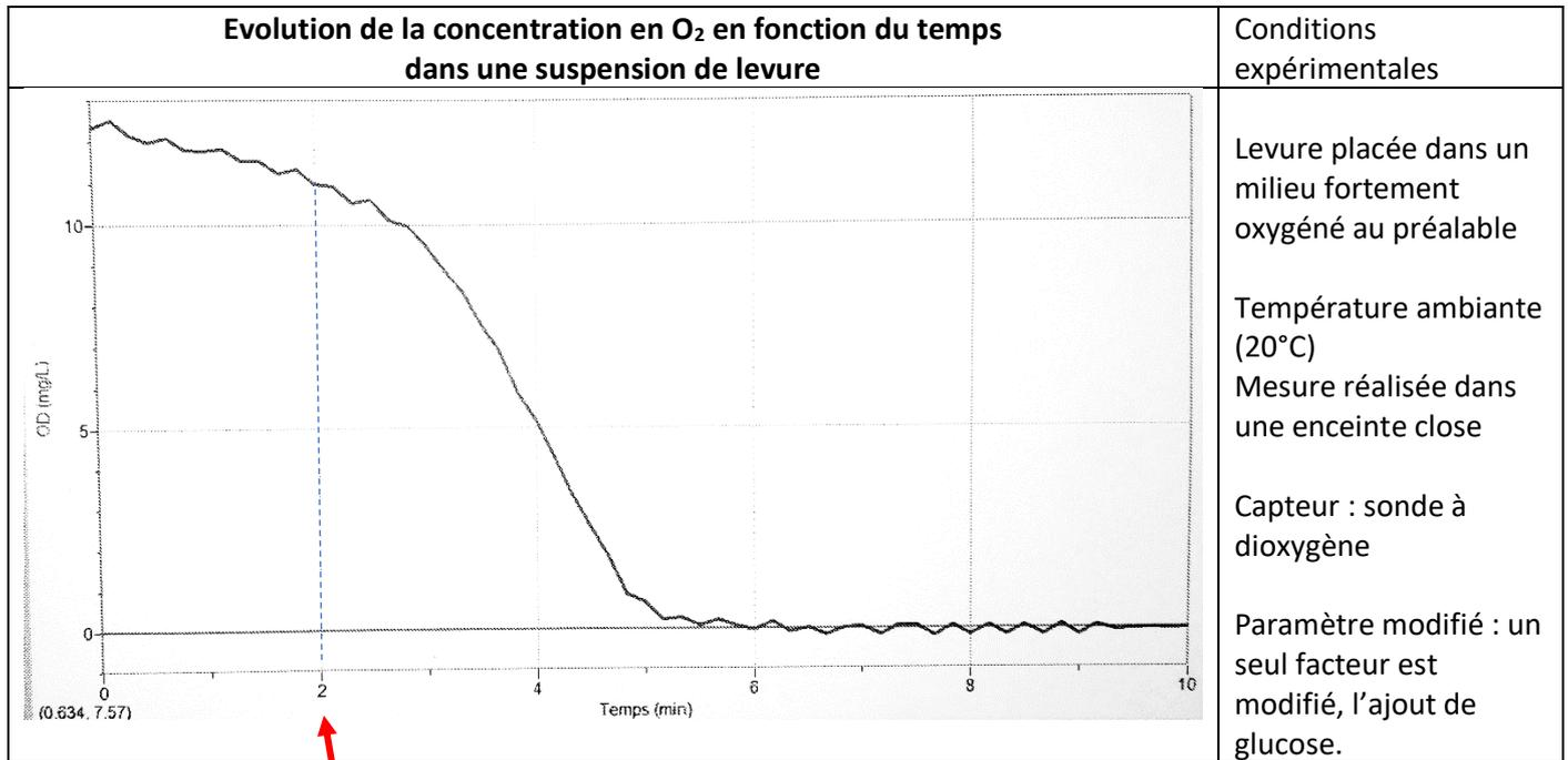
Injection dans le milieu de 0,5 mL de glucose à t = 2min
