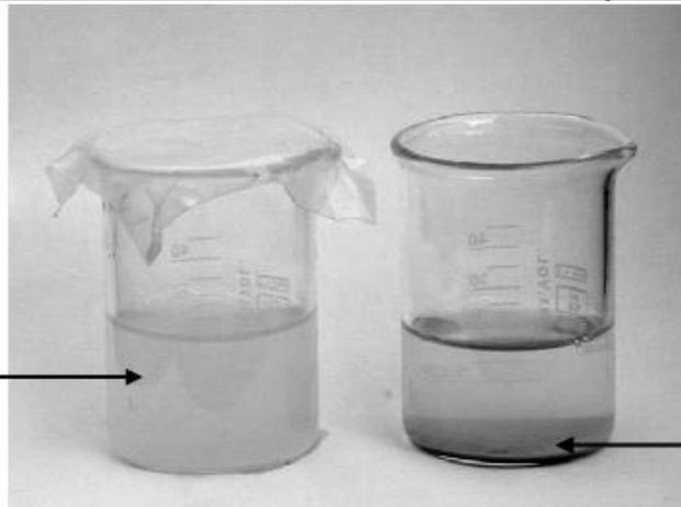
Sous l'action du dioxygène de l'air, la solution de sulfate de fer(II) a formé un précipité rougeâtre. Les ions  $\text{Fe}^{2+}$  ont été oxydés en ions  $\text{Fe}^{3+}$  qui ont précipité aussitôt en oxyde de fer(III)  $\text{Fe}_2\text{O}_3$  et hydroxyde de fer(III)  $\text{Fe}(\text{OH})_3$
